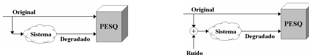
Figura 7.6 – Teste com sinal limpo (esquerda) e com sinal ruidoso (direita).
