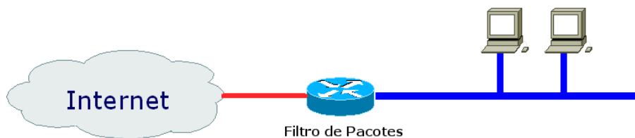
Figura 2.3: Roteador com Listas de Acesso ou Gateway Simples
