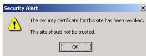
**Figura 6-9.** Mensagem de erro informando uso de certificado revogado pelo servidor.
