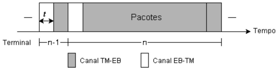
Figura 3.1: Estrutura do quadro do protocolo MSPP
