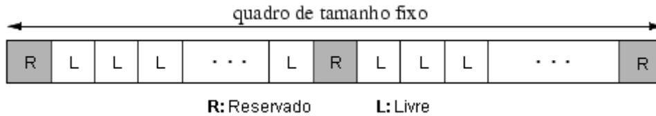
Figura 3.3: Estrutura do quadro do protocolo PRMA
