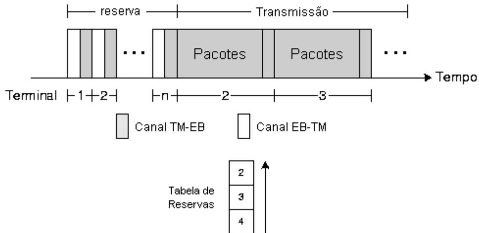
Figura 3.2: Estrutura do quadro do protocolo MSPR
