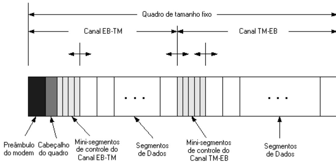
Figura 3.4: Estrutura do quadro do protocolo DR-TDMA
